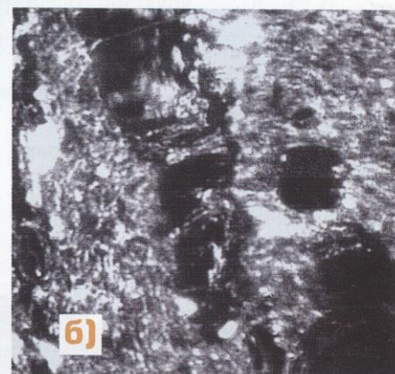
Фото поверхностного слоя (2 мм) резиновой оболочки до начала работы (а) и после одного года работы (б) электрода.
