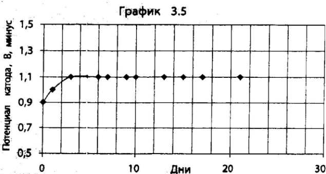
Рис. 3. Испытание анодов на устойчивость в масле
