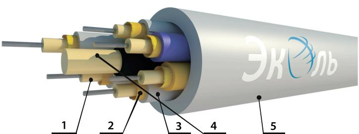
1. - Оптические волокна в плотном буферном покрытии
